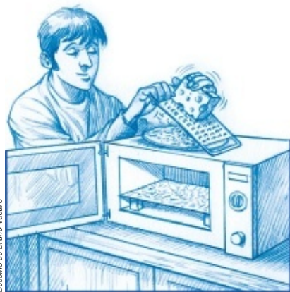
1. CECI N'EST PAS UNE RECETTE... de cuisine, mais de physique : commencez par saupoudrer du gruyère râpé sur une feuille de carton rigide qui reposera dans le four à micro-ondes sur quatre cales de carton. Puis...
