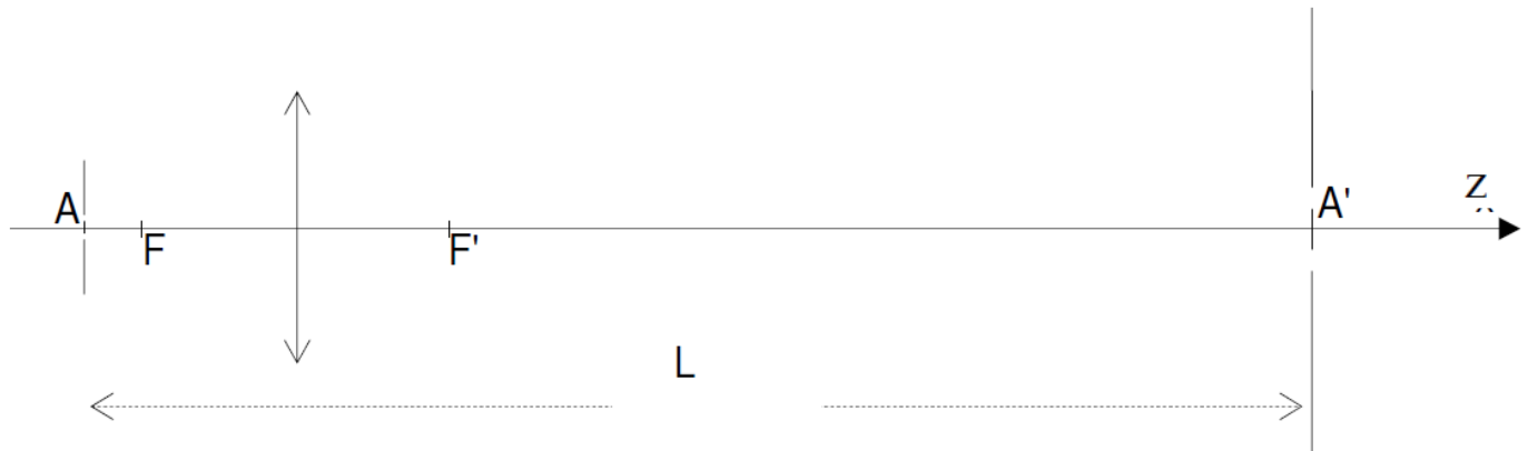
Figure 12 : dispositif de mesure optique de l'écartement
